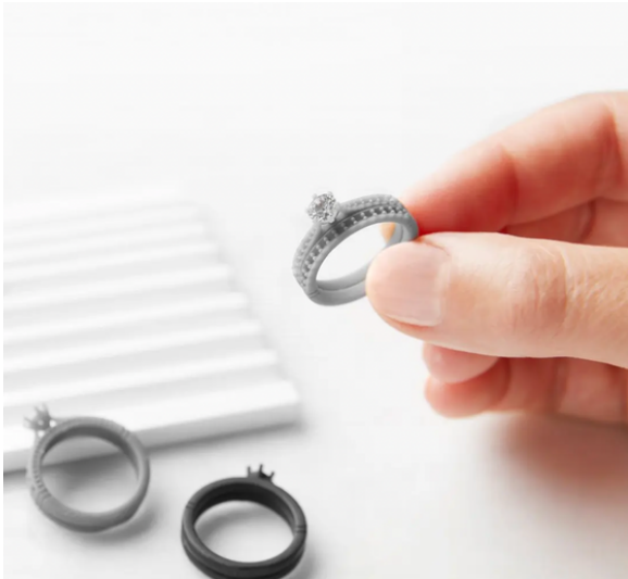
Prototip prstena izrađen iz smole za prototipiranje
