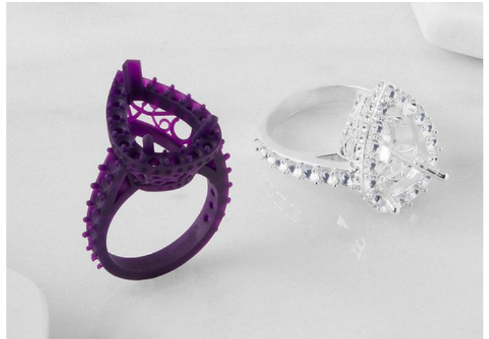
Finalni prsten (desno) izliven po modelu izrađenom od voštane smole (lijevo)
