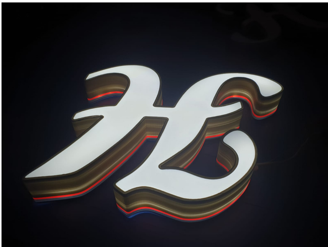
Prototip slova za reklamu, vidljivo je kako debljina stijenke utječe na propusnost svjetlosti
